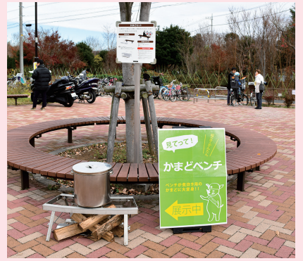
かまどベンチ 普段はベンチですが、災害時には座る部分を外して「かまど」として炊き出しなどに用いることができます。
